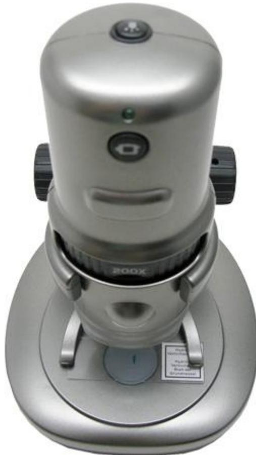
Микроскоп состоит из: предметного столика, стойки основания, рукоятки фокусировки, кнопки захвата изображения, кольца регулировки кратности увеличения изображения.[7].
